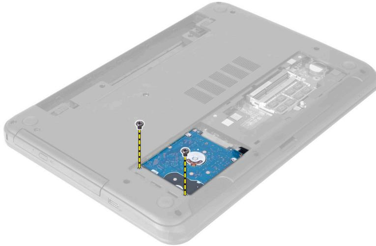
4. Schieben Sie die Festplatte in die dargestellte Richtung und heben Sie die Halterung an, um die Festplatte aus dem Computer zu entfernen.
