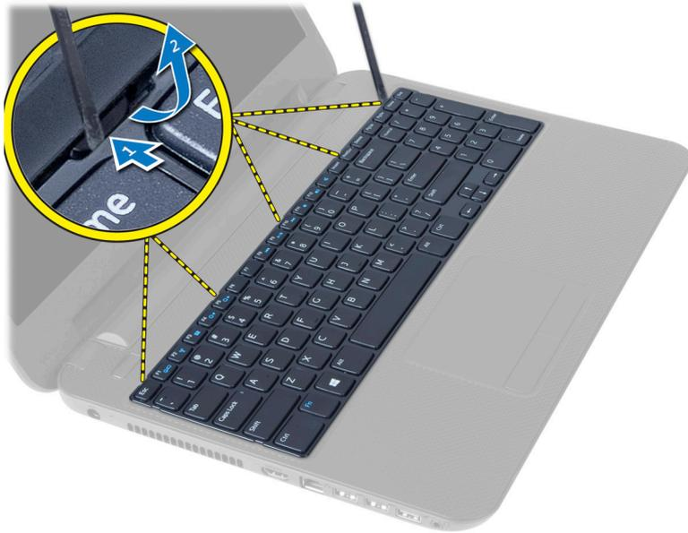
4. Schieben Sie die Tastatur in Richtung der Bildschirmbaugruppe und drehen Sie die Tastatur über der Handballenstützen-Baugruppe um.
