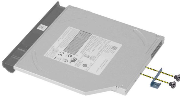
5. Entfernen Sie die Halterung des optischen Laufwerks von der Baugruppe des optischen Laufwerks.
