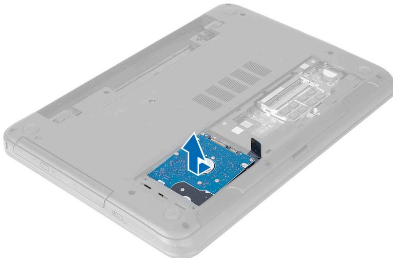
5. Entfernen Sie die Schraube, mit der die Festplattenlaufwerkhalterung am Festplattenlaufwerk befestigt ist, und entfernen Sie sie.
