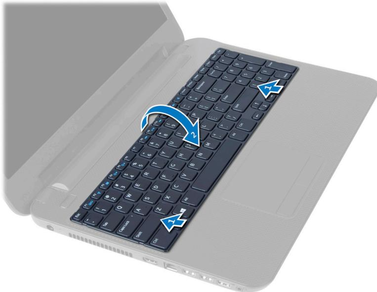
5. Trennen Sie das Tastaturkabel vom Anschluss auf der Systemplatine und heben Sie die Tastatur von der Handballenstützen-Baugruppe.
